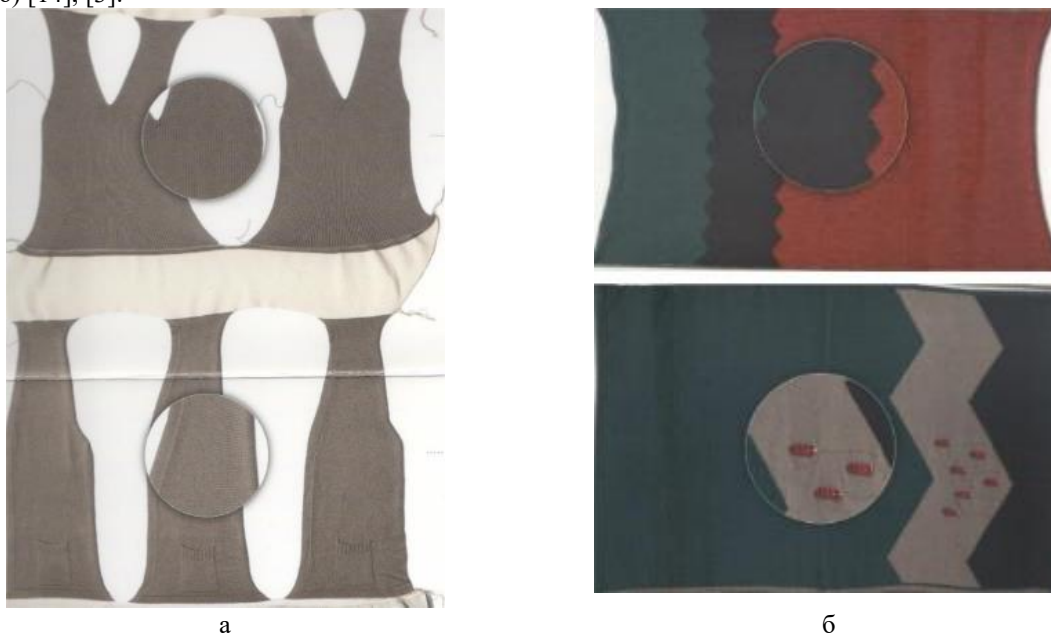
Рис. 2. Примеры возможностей машин с цифровым оснащением из буклета, посвященному истории фирмы Stoll: а – вывязывание деталей изделия по контуру; б - интарзия
