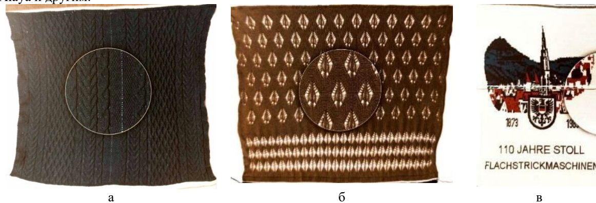
Рис. 1. Примеры трикотажных переплетений из буклета, посвященному истории фирмы Stoll: а – перекрестное; б – ажурное; в – жаккардовое
