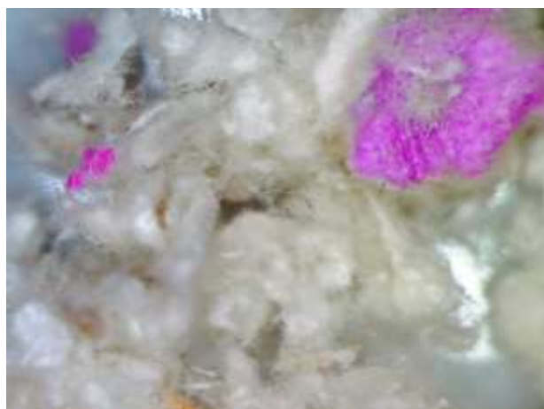
Рис.1. Сорбент ТМ под микроскопом
