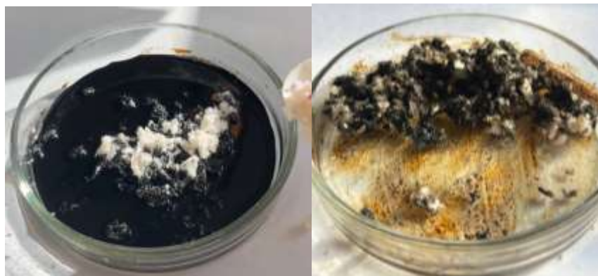
Рис.2. Проверка нефтеемкости сорбента ТМ Ecollose i-sorb
