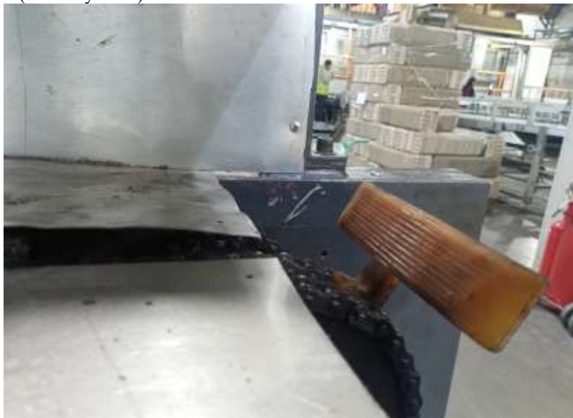
Рис.4. Изготовленная из древесно-полимерного композита лопатка, работающая на линии по производству бугорчатых прокладок для яиц из макулатуры
