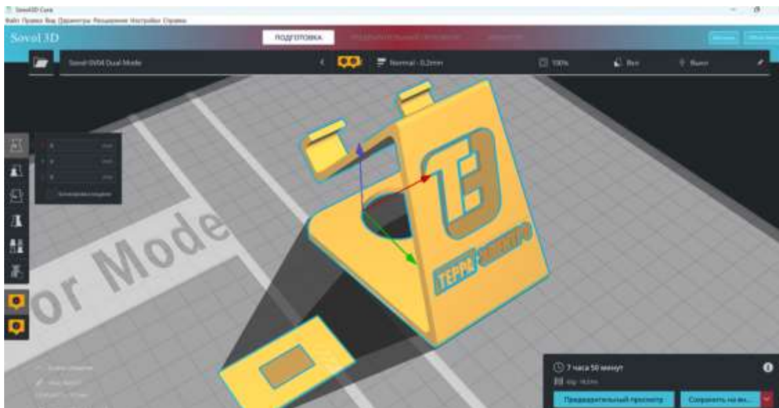
Рис. 12. Результат кодировки двухкомпонентной 3D модели для печати
