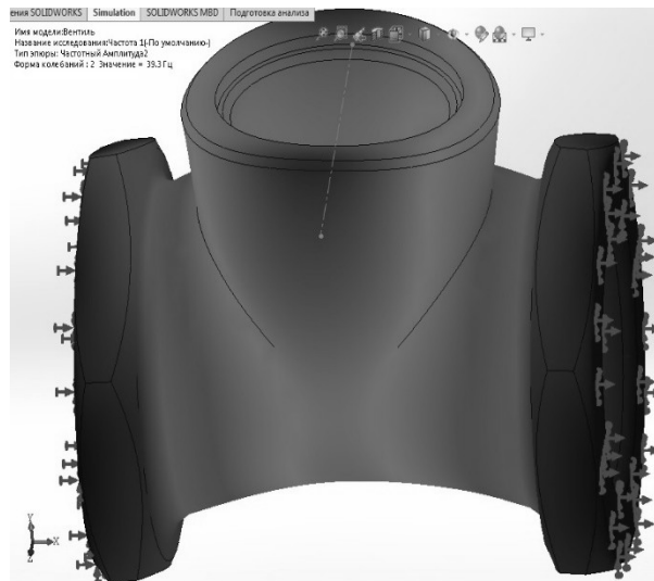
Рис. 5. Вторая форма колебаний модели корпуса запорного вентиля.
