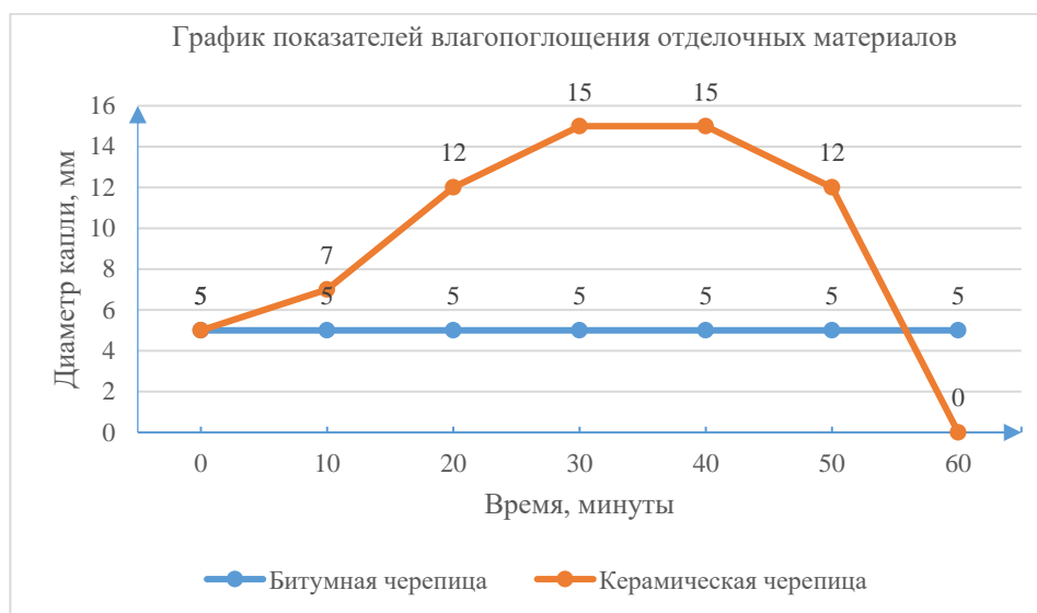
Рис. 2. График показателей влагопоглощения отделочных материалов
