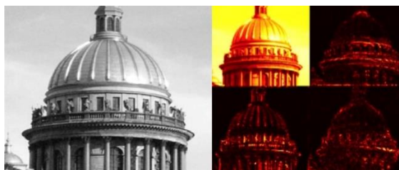
Рис.3. Полутоновое изображение (слева) и структура его вейвлет коэффициентов (справа)
