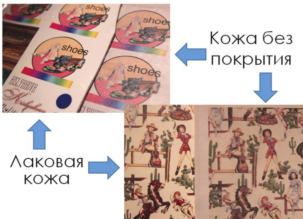
Рис. 5. Результаты эксперимента УФ печати на лаковой коже и коже без обработки
