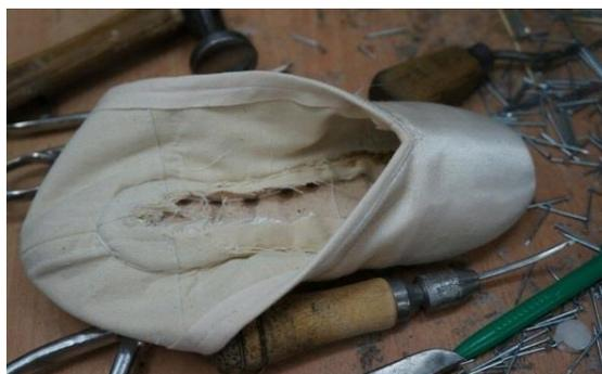
Рис. 10. Операция вклеивания стельки
