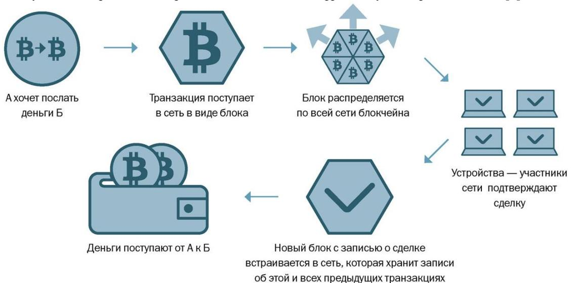
Рис.1. Схема работы блокчейна [2]
