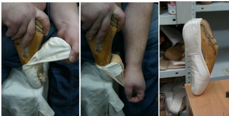
Рис. 9. Снятие, выворачивание, одевание на колодку
