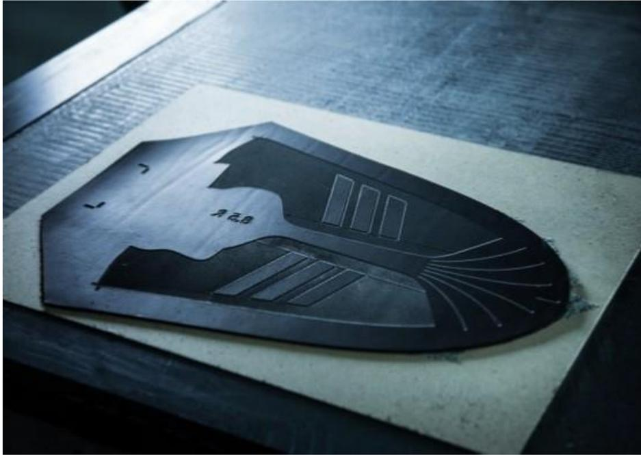
Рис.2. Отфрезерованная деталь заготовки верха обуви из натуральной кожи с прилитым на неё ТПУ рисунком имитации детализировки, фирма Adidas
