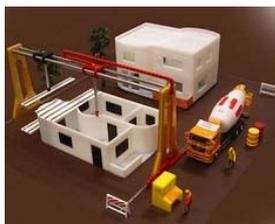
Рис. 2. Макет строительного 3D-принтера по технологии Contour Crafting
