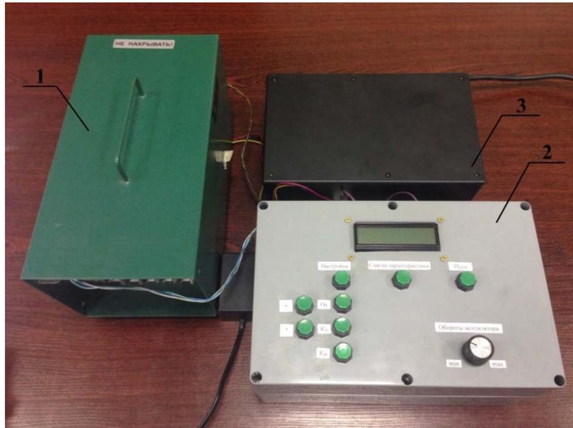
1 – объект управления; 2 – устройство регулирования; 3 – блок питания
