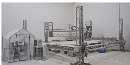
Рис. 1. Строительный 3D-принтер
